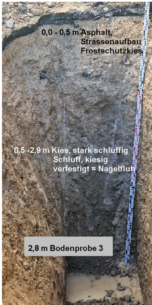
Abbildung 8: Foto Bodenaufschluss Schurf Nr. 4 mit Benennung der angetroffenen Bodenschichten und Bodenprobe 3
