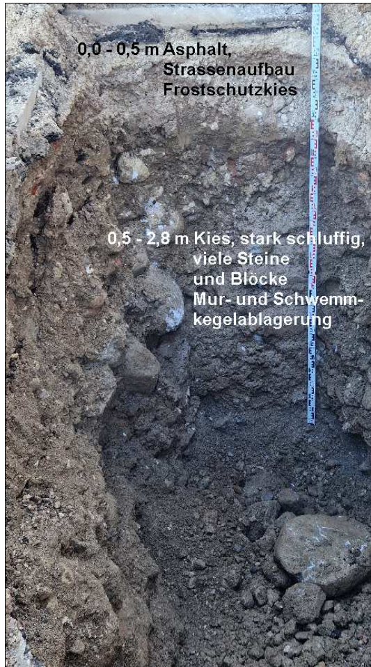
Abbildung 7: Foto Bodenaufschluss Schurf Nr. 3 mit Benennung der angetroffenen Bodenschichten
